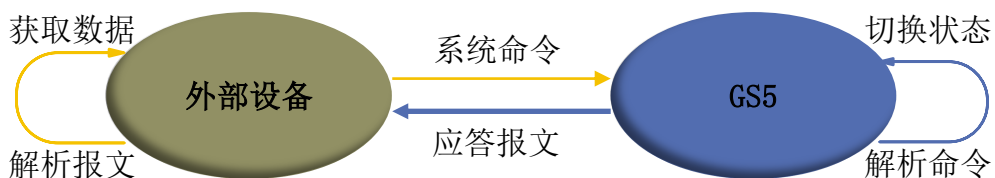
图 3 YDLIDAR GS5 系统通信机制
