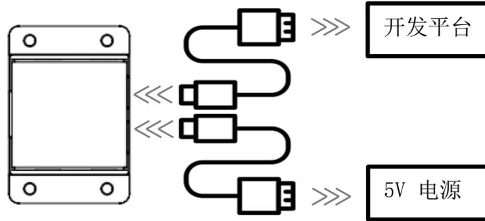
图 4 YDLIDAR T-mini Plus 辅助供电
