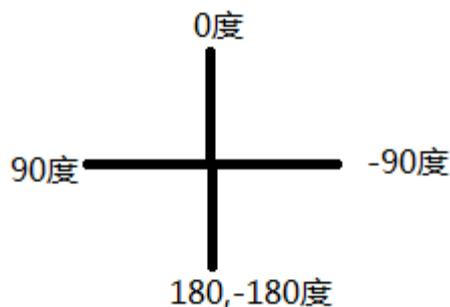
图 22 YDLIDAR T-MINI PLUS 坐标角度定义
