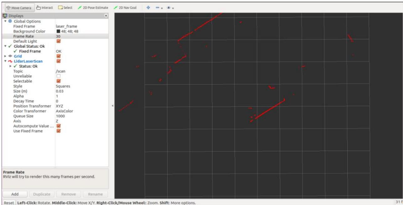
图 20 YDLIDAR T-mini Plus 雷达 rviz 运行显示
