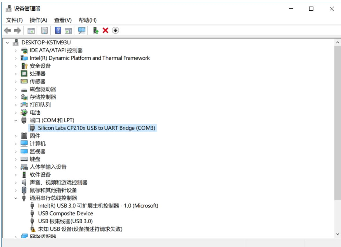
图 7 YDLIDAR T-mini Plus 驱动安装检查
