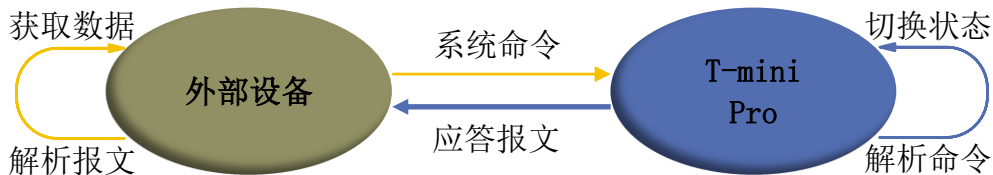
图 2 YDLIDAR T-MINI PRO 系统通信机制
