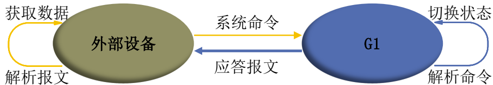
图 2 YDLIDAR G1 系统通信机制
