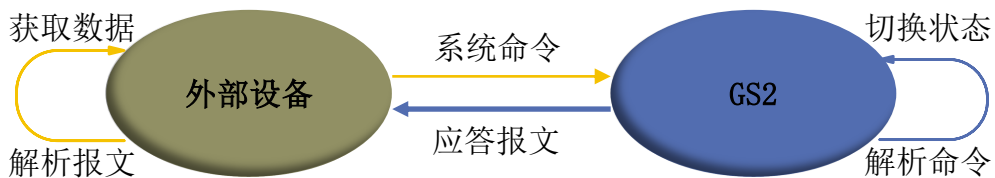
图 3 YDLIDAR GS2 系统通信机制
