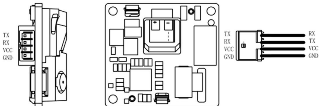
图 3A YDLIDAR GS2-SxxxG01 物理接口
