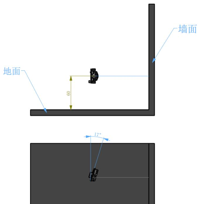
图 2B YDLIDAR GS2 沿边参考安装图 (单位: MM)
