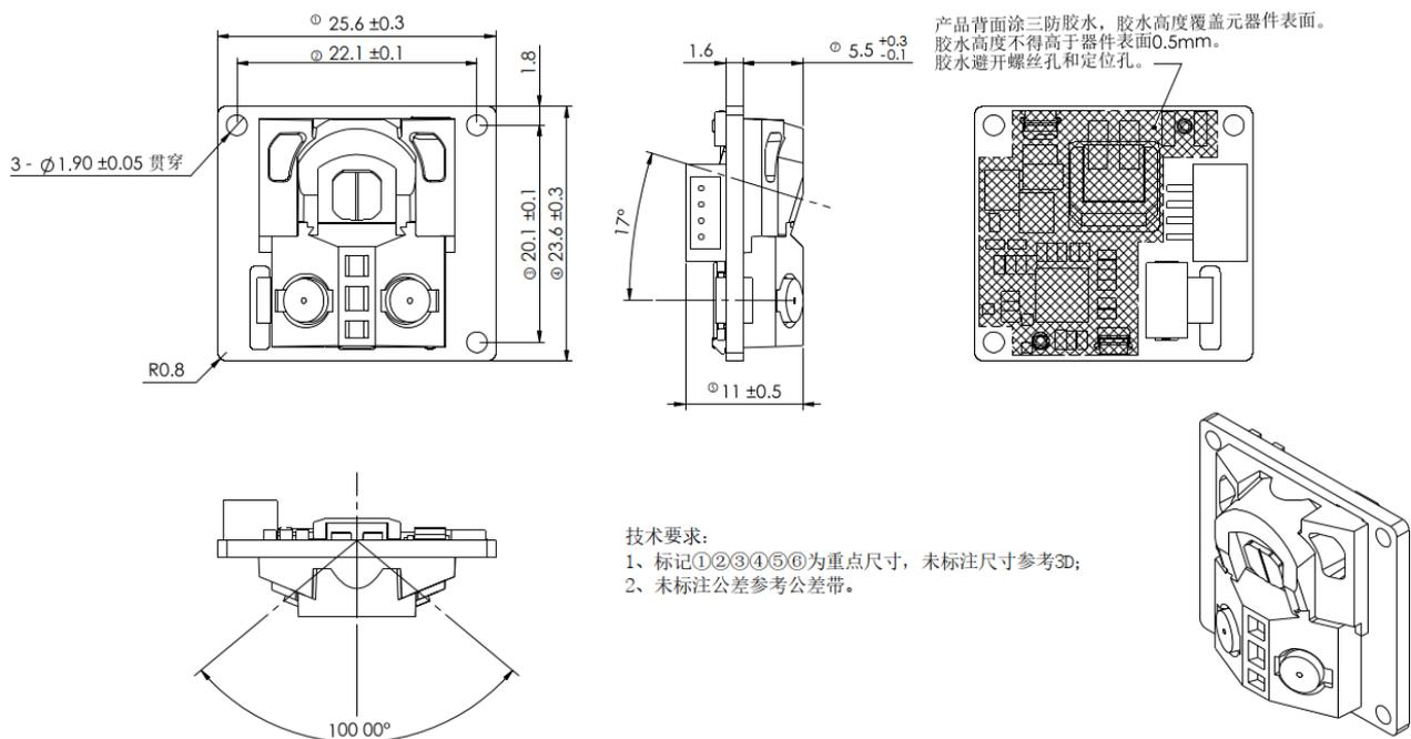
图 1B YDLIDAR GS2-S850G01 机械尺寸 (螺丝规格: PB1.7MM)
