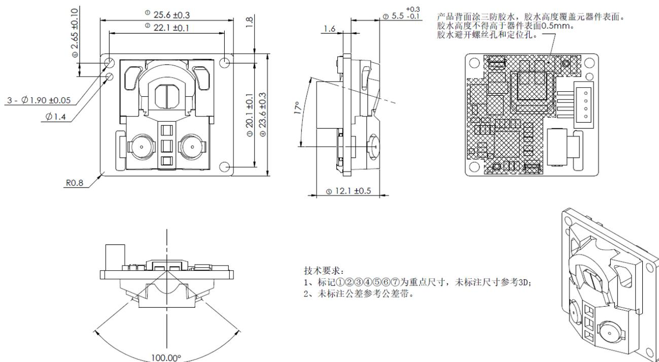
图 1C YDLIDAR GS2-TxxxG01 机械尺寸 (螺丝规格: PB1.7MM)
