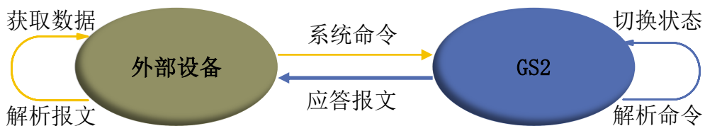
图 3 YDLIDAR GS2 系统通信机制
