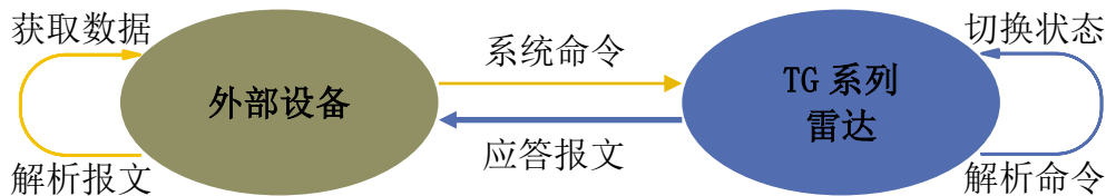
图 2 YDLIDAR TG 系列雷达系统通信机制
