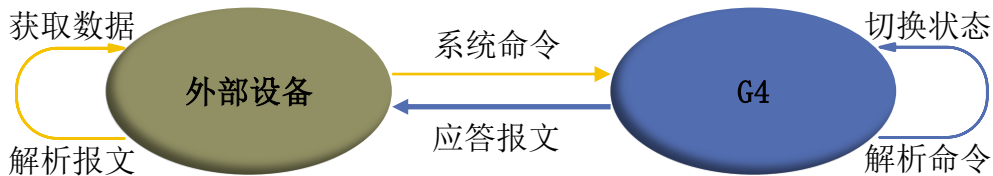
图 2 YDLIDAR G4 系统通信机制
