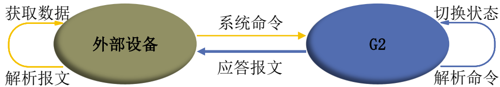
图 2 YDLIDAR G2 系统通信机制
