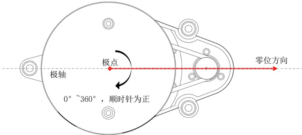
图 4 YDLIDAR X2 极坐标系定义
