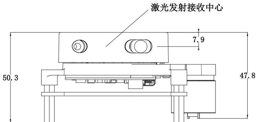
图 1 YDLIDAR X2 正面结构尺寸（单位：MM）
