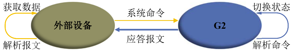
图 2 YDLIDAR G2 系统通信机制
