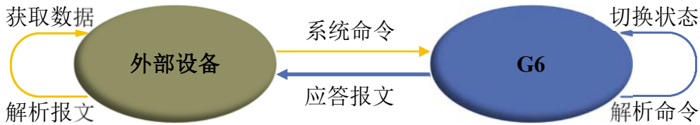
图 2 YDLIDAR G6 系统通信机制
